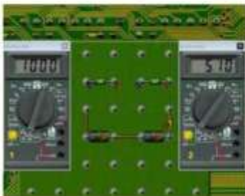
ომმეტრის ჩვენება R_1 = 1000 \text{ ohm} R_2 = 5.1 \text{ kohm} = 5100 \text{ ohm}
