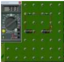
ამპერმეტრის ჩვენება I = 983 \mu\text{A} = 0.000983 \text{ A}
